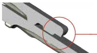
Le joint creux nouvellement développé réduit la pénétration capillaire de l'eau dans le revêtement. Ainsi, la zone sèche plus rapidement et empêche dans une large mesure la formation de mousse et de dépôts de saleté.
